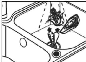
3. Поместите пищевые отходы в измельчитель при помощи пробки-толкателя.
