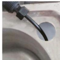
3. Вставьте кнопку и пневматическую трубку в просверлённое отверстие, отрегулируйте положение кнопки.
