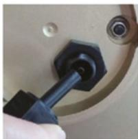
5. Вставьте другой конец пневмотрубки в порт пневмовключателя на задней части измельчителя и зафиксируйте его с помощью стопорного кольца.
