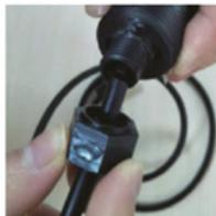
2. Подсоедините конец пневматической трубки к кнопке включения.
