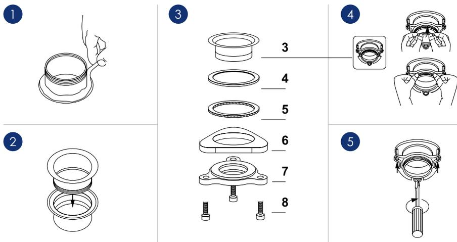
1. Обработать фланец для мойки герметиком.
