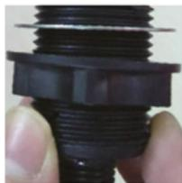
4. Наденьте стопорное кольцо на пневматическую трубку и затяните его до упора.
