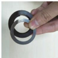
1. Снимите стопорное кольцо пневмовыключателя, оставьте уплотнительную прокладку.
