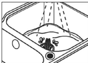
4. Не отключайте измельчитель до тех пор, пока не услышите звук мотора и шум текущей воды внутри измельчителя.
