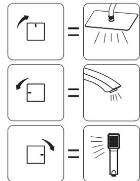
Смеситель оснащён картриджным переключателем, конструкция которого устойчива к гидроударам в момент переключения потоков воды с наполнителя на душевые лейки и обратно.
